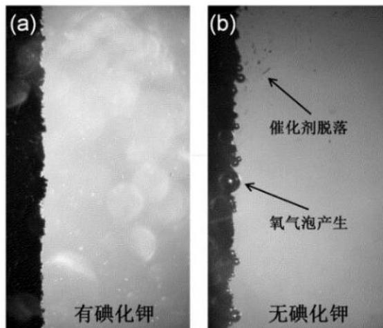
1. 一种低充电电压且充电时无氧气泡产生的锌空气电池,所述锌空气电池包括电解液,其特征在于,所述电解液包括以下组分:氢氧化钾:15-25wt%,碘化钾:25-35wt%,氧化锌:0.5-2wt%,其余为水;
